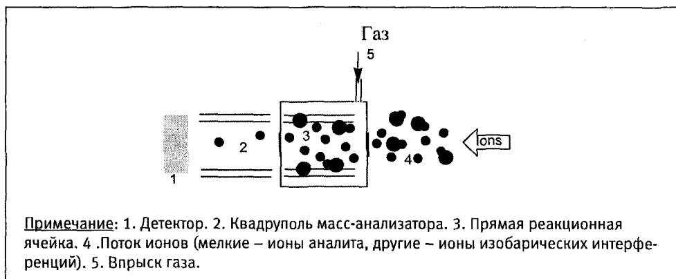
Рис. 72. Схема прибора ИСП-МС с прямой реакционной системой (ПРС).
